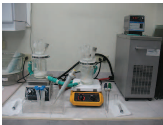
FIGURA 1. EQUIPO DE HIDRÓLISIS ENZIMÁTICA. CONTIENE DOS FRASCOS DE VIDRIO ENCAQUETADOS CON TAPA DE TRES SALIDAS ESMERILADAS, UN RECIRCULADO DE AGUA, UNA PLANCHA CON AGITACIÓN MAGNÉTICA Y UN SISTEMA DE EXTRACCIÓN DE MUESTRA.
